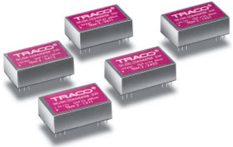
Die TEM 2 Serie ist eine kostengünstige Reihe von 2 W DC/DC-Konvertern im DIL-24 Gehäuse. Sie bieten eine sehr genaue Eingangs-/Lastregulierung und 500 VDC E/A-Isolation. Ein standardmäßig eingebauter Pi-Filter reduziert die Rippleströme am Eingang und gewährleistet eine sehr kleine Restwelligkeit. Diese Serie bietet eine kostengünstige Lösung für eine Vielzahl von kostenkritischen Anwendungen in Industrie- und Elektronikbereichen.
