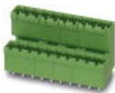
Leiterplattengrundleiste, Nennstrom: 10 A, Polzahl: 3, Rastermaß: 5,08 mm, Farbe: grün, Kontaktfläche: Zinn, Montage: Wellenlöten, Der Artikel ist zu unterschiedlichen Polzahlen anreihbar! Bei Kombination mit MVSTB- oder FKCV-Steckerteilen ist jeweils ein MVSTBW- (bzw. FKCVW-) und ein MVSTBR-Stecker (bzw. FKCVR-) zu verwenden. Kombination mit TMSTBP-Steckerteilen ist nicht möglich!
