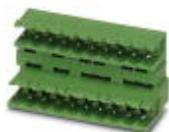
Leiterplattengrundleiste, Nennstrom: 10 A, Polzahl: 3, Rastermaß: 5,08 mm, Farbe: grün, Kontaktoberfläche: Zinn, Montage: Wellenlöten, Anreihbar! Befestigungsflansch: Art.-Nr. 1736771, 1736768. Bei Kombination mit MVSTB- oder FKCV-Steckerteilen ist jeweils ein MVSTBW- (bzw. FKCVW-) und ein MVSTBR-Stecker (bzw. FKCVR-) zu verwenden. Kombination mit TMSTBP-Steckerteilen ist nicht möglich!
