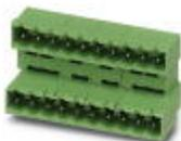
Leiterplattengrundleiste, Nennstrom: 10 A, Polzahl: 3, Rastermaß: 5,08 mm, Farbe: grün, Kontaktfläche: Zinn, Montage: Wellenlöten, Der Artikel ist zu unterschiedlichen Polzahlen anreihbar! Bei Kombination mit MVSTB- oder FKCV-Steckerteilen ist jeweils ein MVSTBW- (bzw. FKCVW-) und ein MVSTBR-Stecker (bzw. FKCVR-) zu verwenden. Kombination mit TMSTBP-Steckerteilen ist nicht möglich!
