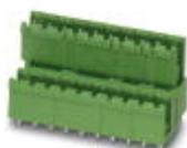
Leiterplattengrundleiste, Nennstrom: 10 A, Polzahl: 3, Rastermaß: 5,08 mm, Farbe: grün, Kontaktoberfläche: Zinn, Montage: Wellenlöten, Anreihbar! Befestigungsflansch: Art.-Nr. 1836477, 1836480. Bei Kombination mit MVSTB- oder FKCV-Steckerteilen ist jeweils ein MVSTBW- (bzw. FKCVW-) und ein MVSTBR-Stecker (bzw. FKCVR-) zu verwenden. Kombination mit TMSTBP-Steckerteilen ist nicht möglich!
