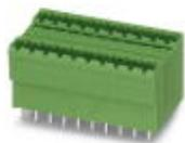
Leiterplattengrundleiste, Nennstrom: 10 A, Polzahl: 3, Rastermaß: 5,08 mm, Farbe: grün, Kontaktoberfläche: Zinn, Montage: Wellenlöten, Bei Kombination mit MVSTB- oder FKCV-Steckerteilen ist jeweils ein MVSTBW- (bzw. FKCVW-) und ein MVSTBR-Stecker (bzw. FKCVR-) zu verwenden. Kombination mit TMSTBP-Steckerteilen ist nicht möglich!
