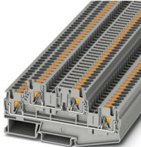
分断接线端子，\*使用的插头决定电流和电压。, 标称工作电压: 500 V, 额定电流: 28 A, 第一层, 接线方式: 直插式连接, 额定接线容量: 4 mm<sup>2</sup>, 接线容量: 0.2 mm<sup>2</sup> - 6 mm<sup>2</sup>, 第2层, 接线方式: 直插式连接, 额定接线容量: 4 mm<sup>2</sup>, 接线容量: 0.2 mm<sup>2</sup> - 6 mm<sup>2</sup>, 安装: NS 35/7.5, NS 35/15, 颜色: 灰色
