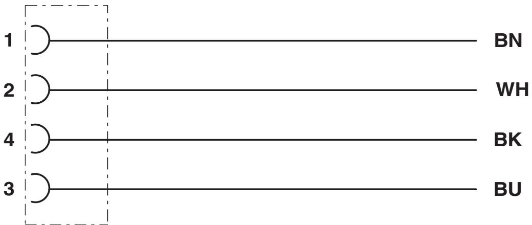
Kontaktbelegung der M8-/M12-Stecker/Buchsen
