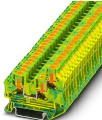
接地端子，连接量: 3，接线方式: 直插式连接，第一层，额定接线容量: 4 mm<sup>2</sup>，横截面: 0.2 mm<sup>2</sup> - 6 mm<sup>2</sup>，安装方式: NS 35/7,5，NS 35/15，颜色: 绿色/黄色
