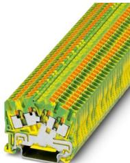
接地端子，连接量: 4，接线方式: 直插式连接，第一层，横截面: 0.14 mm<sup>2</sup> - 4 mm<sup>2</sup>，安装方式: NS 35/7,5，NS 35/15，颜色: 黄绿相间
