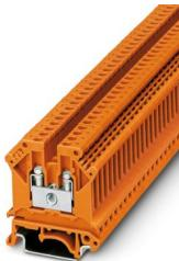
直通式接线端子，标称工作电压: 800 V，额定电流: 24 A，连接量: 2，接线方式: 螺钉连接，额定接线容量: 2.5 mm<sup>2</sup>，横截面: 0.2 mm<sup>2</sup> - 4 mm<sup>2</sup>，安装方式: NS 35/7,5，NS 35/15，NS 32，颜色: 橙色
