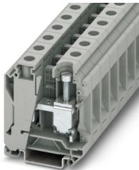
直通式接线端子，标称工作电压: 1000 V，额定电流: 125 A，连接量: 2，接线方式: 螺钉连接，额定接线容量: 35 mm<sup>2</sup>，横截面: 10 mm<sup>2</sup> - 35 mm<sup>2</sup>，安装方式: NS 35/7,5 , NS 35/15，颜色: 灰色
