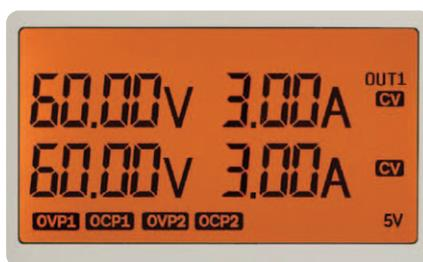
図2. LCDディスプレイには電圧と電流の両方を表示。バックライトのオン／オフが可能
