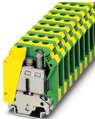
接地端子，使用NS 32...或NS 35...铜导轨，可连接横截面35 mm<sup>2</sup>/2 AWG的导线。使用NS 32...铜导轨，可连接横截面 > 35 mm<sup>2</sup>/2 AWG的导线。用于相同形状的直通端子，端板的绝缘电压> 690 V，连接量: 2，接线方式: 螺钉连接，额定接线容量: 35 mm<sup>2</sup>，横截面: 0.75 mm<sup>2</sup> - 50 mm<sup>2</sup>，安装方式: PE支脚及安装螺钉，M5，安装方式: NS 35/7,5，NS 35/15，NS 32，颜色: 黄绿相间
