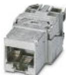
Isolant femelle RJ45, type: RJ45, indice de protection: IP20, nombre de pôles: 8, 10 Gbit/s, CAT6<sub>A</sub>, matériau: Zinc coulé sous pression, type de raccordement: Raccordement IDC, section raccordable: AWG 26- 22, sortie du câble: droite, Modèle sans adaptateur
