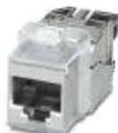
Isolant femelle RJ45, type: RJ45, indice de protection: IP20, nombre de pôles: 8, 10 Gbit/s, CAT6<sub>A</sub>, matériau: Zinc coulé sous pression, type de raccordement: Raccordement IDC, section raccordable: AWG 26- 22, Exécution keystone uniquement utilisable avec un cadre IP20 ou une intégration directe sur la paroi du boîtier
