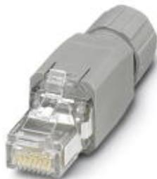
Connecteur RJ45, indice de protection: IP20, nombre de pôles: 8, 1 Gbit/s, CAT5 (CEI 11801:2002), matériau: PA, type de raccordement: Raccordement autodénudant IDC, section raccordable: AWG 26- 23, sortie du câble: droite, coloris: gris signalisation A RAL 7042
