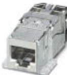
Isolant femelle RJ45, type: RJ45, indice de protection: IP20, nombre de pôles: 8, 10 Gbit/s, CAT6<sub>A</sub>, matériau: Zinc coulé sous pression, type de raccordement: Raccordement IDC, section raccordable: AWG 26- 22, Exécution Freetnet pour une utilisation avec des cadres IP67 et des blocs de prise
