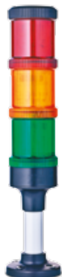
Référence: ECO60-Q01 Couleurs: rouge-orange-vert Fonction: Feu LED fixe Tension nominale: 24 V AC/DC Type de montage: Montage de tube (longueur de tube 100 mm)
