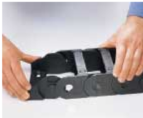
7. Insérer l'élément de fixation de biais et emboîter le boulon et le perçage l'un dans l'autre
