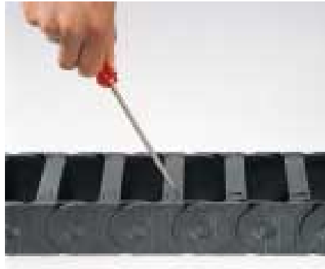
1. Ouverture : Appliquer une légère pression sur le tournevis puis soulever
