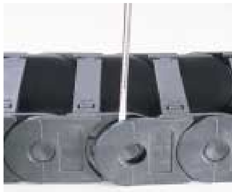
5. Séparation de la chaîne par insertion sur le côté et soulèvement avec le tournevis formant levier
