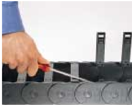
3. Fermeture par le pouce, utiliser un marteau en caoutchouc ou un tournevis en faisant levier
