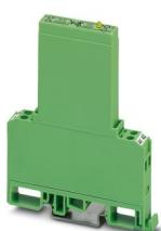
Eingabe-Solid-State-Relais, mit Leuchtanzeige und Schutzbeschaltung im Ein- und Ausgangskreis, Eingang: 220 V DC, Ausgang: 4 - 48 V DC/max. 100 mA
