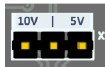
Fig. 14. – Jumper zur Auswahl des Analogsignalbereichs
