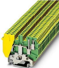
接地端子，连接量: 4，接线方式: 螺钉连接，第一层，横截面: 0.2 mm<sup>2</sup> - 4 mm<sup>2</sup>，安装方式: PE支脚及安装螺钉，M2.5，安装方式: NS 35/7,5，NS 35/15，NS 32，颜色: 黄绿相间
