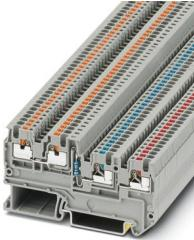
启动器/执行器接线端子，带100 kOhm电阻，标称工作电压: 250 V，额定电流: 13.5 A，连接量: 4，接线方式: 直插式连接，额定接线容量: 1.5 mm<sup>2</sup>，横截面: 0.14 mm<sup>2</sup> - 1.5 mm<sup>2</sup>，安装方式: NS 35/7,5，NS 35/15，颜色: 灰色
