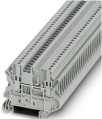
直通式接线端子，带测试插座螺栓，用于插入测试插头，标称工作电压: 630 V，额定电流: 24 A，连接量: 2，接线方式: 螺钉连接，额定接线容量: 2.5 mm<sup>2</sup>，横截面: 0.14 mm<sup>2</sup> - 4 mm<sup>2</sup>，安装方式: NS 35/7,5，NS 35/15，颜色: 灰色
