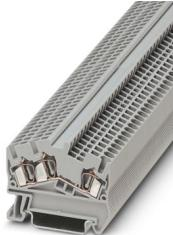
直通式接线端子，标称工作电压: 800 V，额定电流: 24 A，连接量: 3，接线方式: 回拉式弹簧连接，第一层，额定接线容量: 2.5 mm<sup>2</sup>，横截面: 0.08 mm<sup>2</sup> - 4 mm<sup>2</sup>，安装方式: NS 35/7.5，NS 35/15，颜色: 灰色
