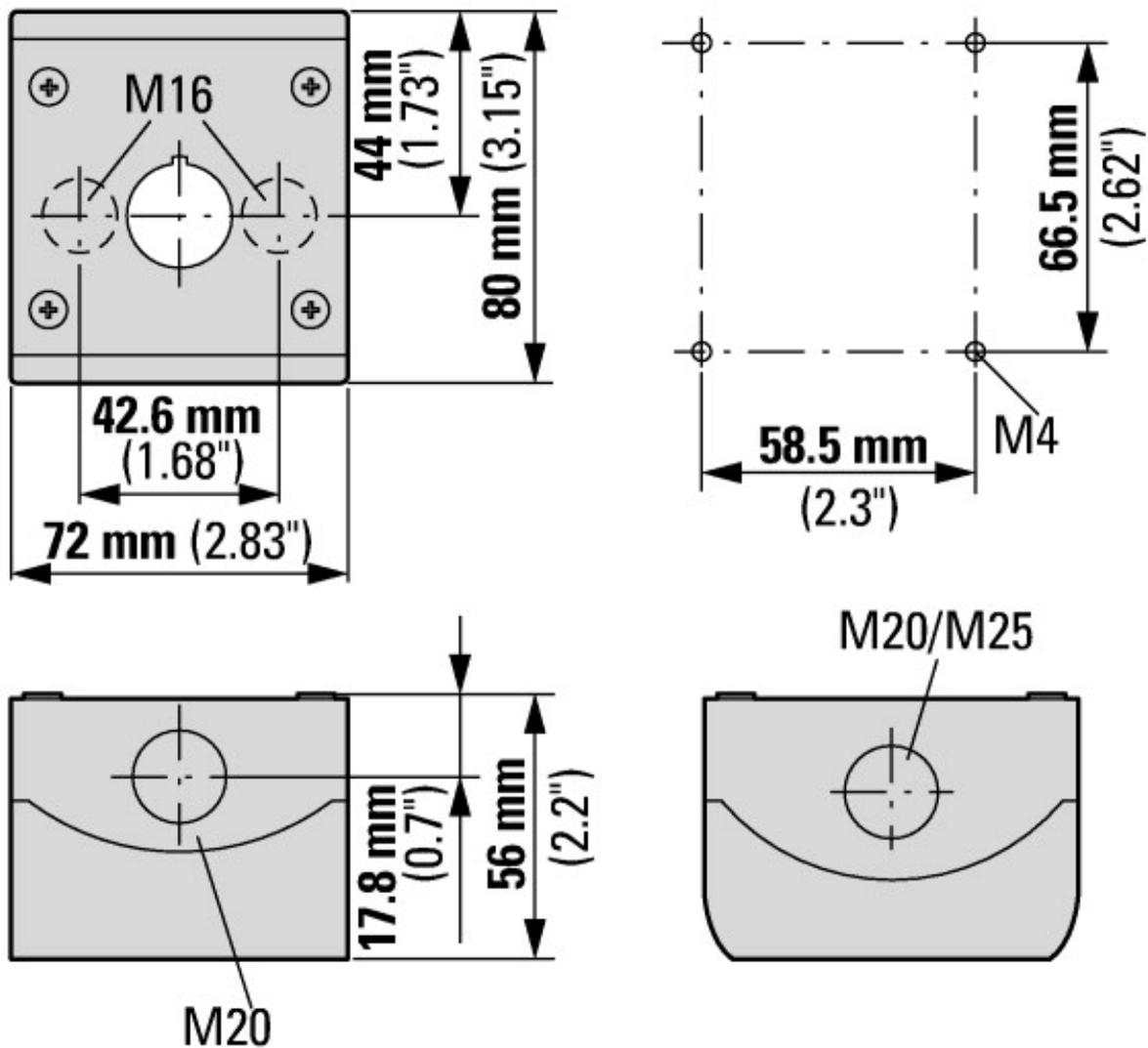
Passage de câble prédécoupée : en bas 2 x M16 ; en haut : 1 x M20, côté : 2 x M20/M25 (1 par côté)
