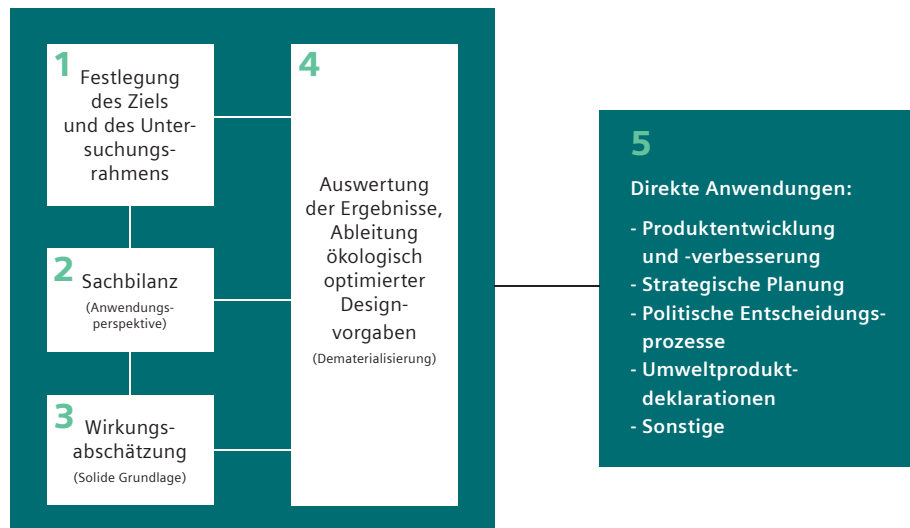
Abbildung 2 Das von Siemens verwendete RED in Bezug zu den fünf Phasen einer LCA nach ISO-Norm
