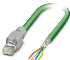
Câble EtherCAT® équipé, blindé, quarte en étoile, AWG 22 souple (7 fils), RAL 6018 (jaune-vert), connecteur mâle RJ45/IP20, 4 pôles sur extrémité libre, longueur : 2 m
