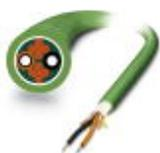
Cavo in fibra polimerica PROFINET, duplex 980/1000  $\mu\text{m}$ , esecuzione pesante altamente flessibile per applicazioni con catene portacavi, senza connettore
