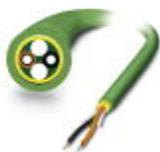
Cavo per l'installazione POF-PROFINET confezionabile (solo teste IP20) per la posa in macchine e impianti stazionari, elementi singoli in poliammide (PE), senza alogenati, resistente a ozono e raggi UV, con guaina esterna in poliuretano (PUR) rinforzato
