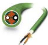
Cavo PROFINET POF confezionabile e altamente flessibile (solo teste IP20), per l'impiego in catene portacavi. Elementi singoli in poliammide (PE) ad elevata resistenza. Il cavo è privo di alogenati, resistente all'ozono e ai raggi UV, con robusta guaina esterna in poliuretano (PUR).
