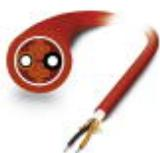
Cavo tondo Profinet POF confezionabile e altamente flessibile (solo teste IP20) per l'impiego in catene portacavi. Elementi singoli in poliammide (PE) ad elevata resistenza. Il cavo è privo di alogenati, resistente all'ozono e ai raggi UV grazie alla robusta guaina esterna in poliuretano (PUR).
