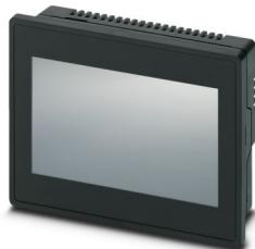
Touchpanel, 10.92 cm / 4.3"-TFT Display (analog-resistiv), 480 x 272 Pixel (WQVGA), 16,7 Mio. Farben, Arm® Cortex®-A7, 528 MHz i.MX6 UL, 2x COM (RS-232/422/485), 1x USB 2.0, Typ A, 1x USB 2.0, Typ B, 1x Ethernet (10/100 MBit/s), RJ45, Windows® Embedded Compact 7, Visu+, ohne Bussystem.
