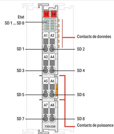
Cette borne de sorties digitales (T.O.R.) de seulement 12 mm de largeur dispose de 8 canaux. L'automate programmable transmet ses signaux de commande aux actionneurs connectés par l'intermédiaire des bornes de sorties digitales. Toutes les sorties sont protégées contre les courts-circuits. La séparation galvanique bus de terrain/bornes est assurée par des optocoupleurs.
