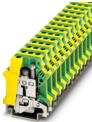
接地端子，当与同样规格的直通端子对齐排置时，必须插入一个端板以隔离大于 690 V 的电压。
