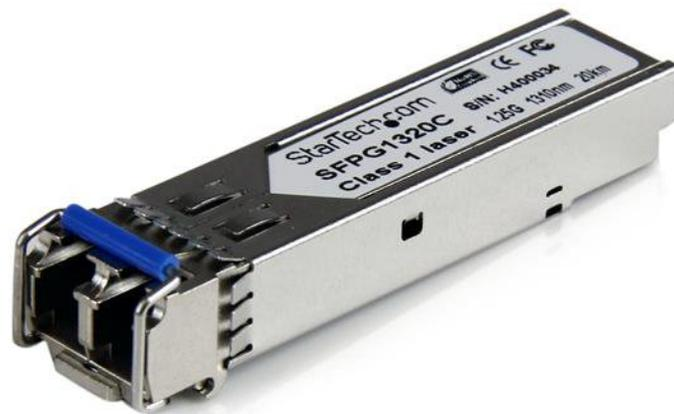
El modelo SFPG1320C es un módulo transceptor por fibra óptica compatible con Cisco GLC-LH-SMD, diseñado, programado y probado para su funcionamiento con enrutadores y conmutadores de la marca Cisco®. Ofrece conectividad fiable a 1GbE a través de cableado de fibra, para redes compatibles con 1000BASE-LH, a una distancia máxima de hasta 20km.
