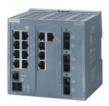
SCALANCE XB213-3LD managebarer Layer 2 IE Switch 13x 10/100 Mbit/s RJ45 Ports, 3x SM FO SC-Port 1x Konsolen-Port, Diagnose-LED, redundante Spannungsversorgung, IEC 62443-4-2 zertifiziert; Temp.-Bereich 0°C bis +60°C; Hutschienenmontage; Default-EtherNet/IP.
