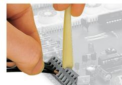
Raccordement des conducteurs, avec outil de manipulation
