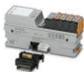
Axioline F、デジタルI/Oモジュール、デジタル入力: 8、24 V DC、接続方式: 1線式、デジタル出力: 8、24 V DC、500 mA、接続方式: 1線式、ローカルバスの伝送速度: 100 Mbps、保護等級: IP20、バスベースモジュールとAxioline F コネクタを含む
