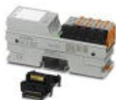
Axioline F、アナログI/Oモジュール、アナログ入力: 2、0 V ... 5 V、-5 V ... 5 V、0 V ... 10 V、-10 V ... 10 V、0 mA ... 20 mA、4 mA ... 20 mA、-20 mA ... 20 mA、接続方式: 2線式、アナログ出力: 2、0 V ... 5 V、-5 V ... 5 V、0 V ... 10 V、-10 V ... 10 V、0 mA ... 20 mA、4 mA ... 20 mA、-20 mA ... 20 mA、接続方式: 2線式、ローカルバスの伝送速度: 100 Mbps、保護等級: IP20、バスベースモジュールとAxioline F コネクタを含む
