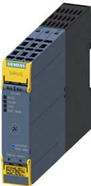
故障安全型可逆起动器, 3RM1, 500V, 0.55 - 3 kW, 1.6 ... 7 A, 110-230 V AC, 弹簧型端子 (直插式)
