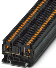
保险丝接线端子，保险丝类型: 扁形，保险丝类型: ISO 8820-3 F型 (微型)，标称工作电压: 400 V，额定电流: 10 A，接线方式: 直插式连接，额定接线容量: 4 mm<sup>2</sup>，接线容量: 0.2 mm<sup>2</sup>- 6 mm<sup>2</sup>，安装方式: NS 35/7,5, NS 35/15，颜色: 黑色
