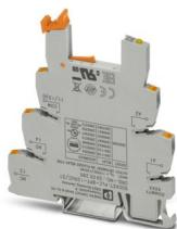
6,2 mm PLC-Grundklemme mit Push-in-Anschluss, ohne Relais- oder Solid-State-Relaisbestückung, zur Montage auf Tragschiene NS 35/7,5, 1 Wechsler, Eingangsspannung 120 V AC/DC
