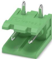
PCB插座，额定横截面: 2.5 mm<sup>2</sup>，颜色: 绿色，额定电流: 12 A，额定电压(III/2): 320 V，触点表面: Sn，触点类型: 针式插头，电位数: 2，行数: 1，位数: 2，连接量: 2，产品系列: MSTB 2,5/-GU，针距: 5 mm，安装: 波峰焊，针脚排列: 直线排列，焊针[P]: 3.3 mm，每个电势的焊针数量: 1，插拔系统: COMBICON MSTB 2,5，针式连接器样式对齐: 反向，互锁: 不带，安装方式: 不带，包装类型: 纸箱包装
