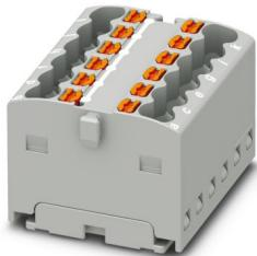
接线板，底座端子，标称工作电压: 450 V，额定电流: 17.5 A，连接量: 12，接线方式: 直插式连接，横截面: 0.14 mm<sup>2</sup> - 2.5 mm<sup>2</sup>，安装方式: 用于卡接在DIN导轨适配器上，直接安装，带法兰，自由悬挂，颜色: 灰色
