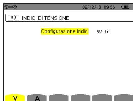
Figura 28: Lo schermo Indici di tensione nel menu Sensore e indici in caso di un montaggio con neutro
