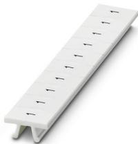
クイックマーカ、ラベリング、白、マーキングあり、ラベリング可能 : CMS-P1-PLOTTER、横方向に印字: 同じ数字を印字 ( 1、2など、100まで )、取付けタイプ: スナップ式、端子台幅 : 6.2 mm、印字エリア: 6.15 x 10.5 mm、個別ラベル数: 10
