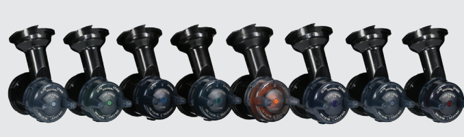
Buse de pulvérisation 3M™ Finition Fine par gravité 0.9, 1.1, 1.2, 1.3, 1.4, 1.6, 1.8, 2.0 mm
