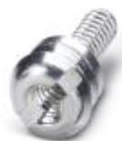
Tornillo con enclavamiento, rosca 4-40 UNC, para uso en montaje en pared trasera, grosor máx. de la pared de la carcasa 1,5 mm
