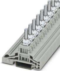
大电流端子，标称工作电压: 1000 V，额定电流: 125 A，连接量: 1，接线方式: 螺栓连接，额定接线容量: 35 mm<sup>2</sup>，安装方式: NS 35/7,5，NS 35/15，颜色: 灰色
