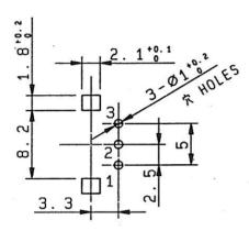
端子取付穴寸法図(挿入側より見た図) (許容差±0.1) MOUNTING HOLE DETAIL (TOLERANCE±0.1) VIWED FROM MOUNTING SIDE 板厚 t=1.6
