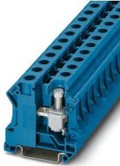
建筑安装端子，标称工作电压: 400 V，额定电流: 76 A，螺钉连接，第1层右边连接，额定接线容量: 16 mm<sup>2</sup>，横截面: 6 mm<sup>2</sup> - 25 mm<sup>2</sup>，安装方式: NS 35/7,5，NS 35/15，颜色: 蓝色
