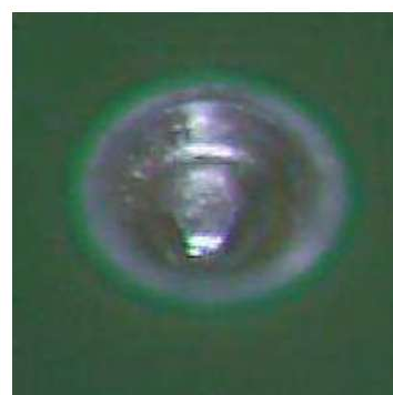
Soldered Data Pin 焊接数据引脚
