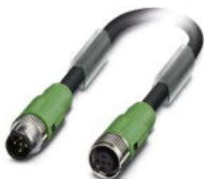
センサ/アクチュエータケーブル, 5-極, PUR, 黒-灰RAL 7021, プラグ ストレート M12 SPEEDCON, Aコーディング, 上 ソケット ストレート M12 SPEEDCON, Aコーディング, ケーブル長: 0.13 m
