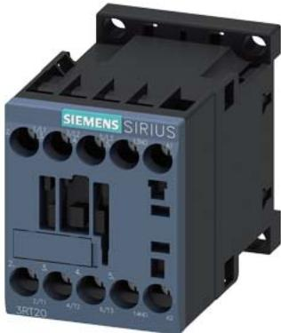
Leistungsschütz, AC-3e/AC-3, 12 A, 5,5 kW / 400 V, 3-polig, AC 100 V, 50 Hz / 100-110 V, 60 Hz, Hilfskontakte: 1 S, Schraubanschluss, Baugröße: S00
