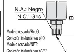
N.A.: Negro<br>N.C.: Gris<br>Modelo roscado/Rc, G: Conexión instantánea ø10<br>Modelo roscado/NPT: Conexión instantánea ø3/8" |
