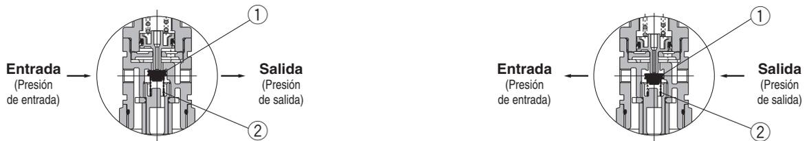
Cuando la presión de entrada supera la presión de regulación, la válvula antirretorno funciona como un regulador normal (figura 1). Cuando la presión de entrada ( $P_1$ ) se cierra y se evacua, toda presión aplicada a la válvula ① se perderá. La fuerza de la válvula de asiento ① sólo se debe a la fuerza del muelle de la válvula ②. Cuando la válvula ① se abre mediante la fuerza de salida, la presión de salida se evacua en el lado de entrada. (figura 2)
