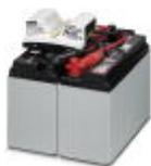
Accumulateur d'énergie, AGM au plomb, technologie VRLA 24 V DC, 13 Ah, changement de batterie sans outil, détection automatique et communication avec QUINT UPS-IQ
