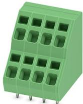
印制电路板终端，额定电流: 17.5 A，额定电压(III/2): 400 V，额定横截面: 2.5 mm<sup>2</sup>，电位数: 8，行数: 2，每行位数: 4，产品系列: ZFKKDS(A) 2,5，针距: 5.08 mm，接线方式: 回拉式弹簧连接，安装: 波峰焊，导线/PCB连接方向: 45°，颜色: 绿色，针脚排列: 直线排列，焊针[P]: 3.5 mm，每个电势的焊针数量: 1，包装类型: 纸箱包装
