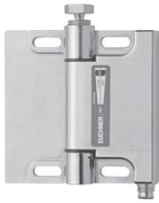
Die Schaltcharniere ESH sind sicherheitstechnische Einrichtungen zur Überwachung von beweglichen trennenden Schutzvorrichtungen, wie Türen oder Abdeckungen an Maschinen oder Anlagen. Bei den Schaltcharnieren ESH-ARO... lässt sich der Schaltpunkt beliebig oft einstellen.
