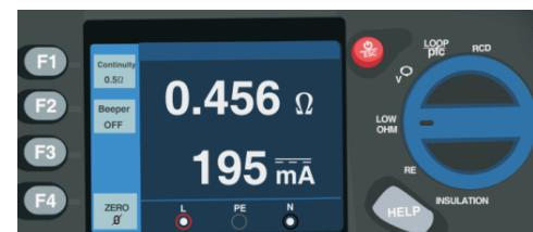
Ein Durchgangsprüfung wird verwendet, um die Integrität von Verbindungen durch eine hochauflösende Widerstandsmessung zu überprüfen. Dies ist besonders wichtig für die Prüfung von Schutzeleiteranschlüssen.
