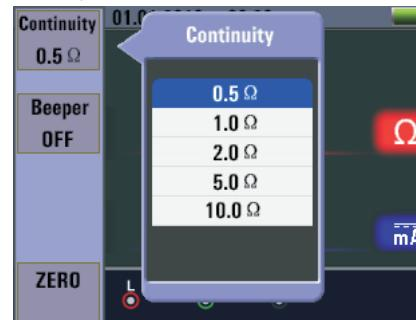
Bouton F1: menu déroulant et arrêt LOW OHM, le mode d'arrêt est activé lorsque l'opérateur sélectionne.
