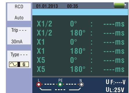
Abbildung 14 RCD-Standby-Bildschirm
