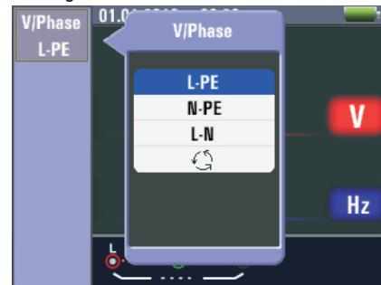
Bouton F1: Pop-up et arrêt Menu Voltage / Phase, le mode Shutdown est activé lorsque l'opérateur sélectionne.
