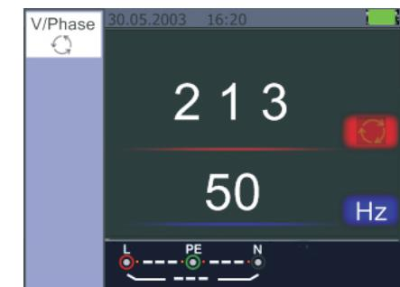
Abb. 24 Phasenfolge - Wenn gegen den Uhrzeigersinn angeschlossen
