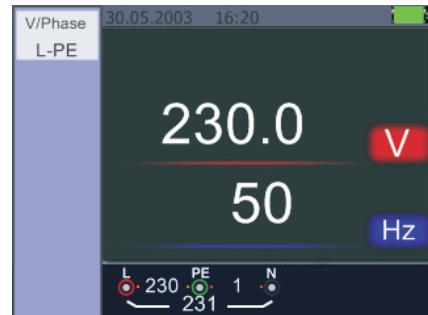
Figure 20 Écran lors de la mesure de la tension et de la fréquence
