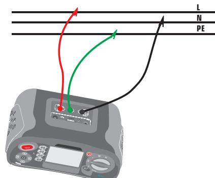
Abbildung 8 Anschluss der Hi Ampere LOOP-Testleitung
