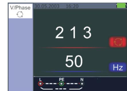
Figure 24 Séquence de phase: lorsqu'elle est connectée dans le sens inverse des aiguilles d'une montre
