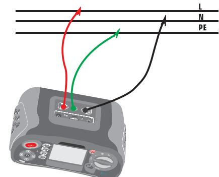
Figure 8 Connexion du fil Hi Amp LOOP-Test
