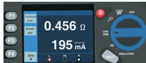
Un test de continuité est utilisé pour vérifier l'intégrité des connexions en effectuant une mesure de résistance à haute résolution. Ceci est particulièrement important pour vérifier les connexions de terre de protection.
