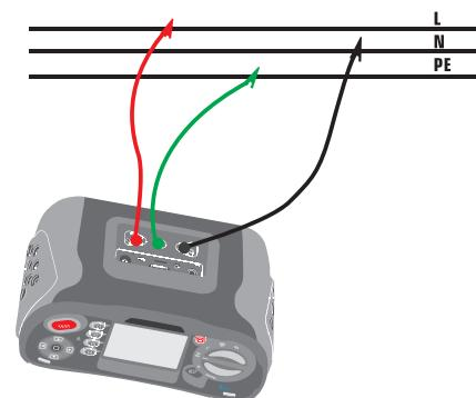
Abbildung 22 Anschluss der Phasenfolge-Prüfleitung
