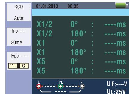
Abbildung 16 RCD-Bildschirm mit Auto-Funktion
