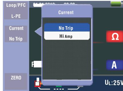
Bouton F1: menu déroulant et arrêt du menu Boucle / PFC, le mode d'arrêt est activé lorsque l'opérateur sélectionne.
