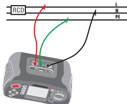
Bild 4 Kein Anschluss der LOOP-Prüfleitung für Auslösung
