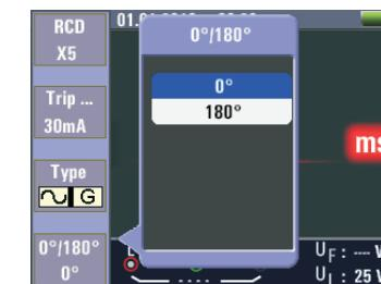
Bouton F1: menu RCD contextuel et arrêt, le mode d'arrêt est activé lorsque l'opérateur sélectionne.
