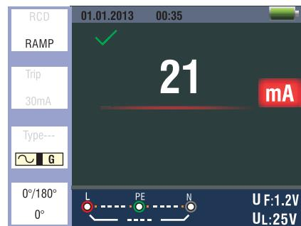
Abbildung 18 RCD Rampen-Mess-Bildschirm
