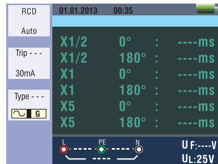
Figure 14 RCD-Standby screen
