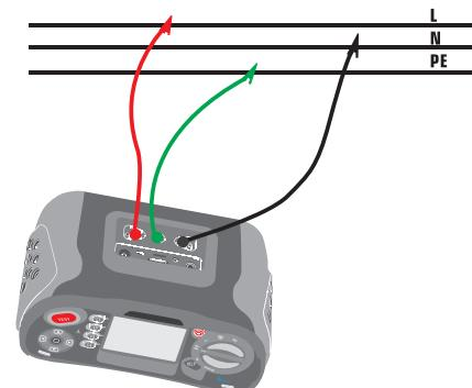
Figure 22 Connexion de la séquence de phase
