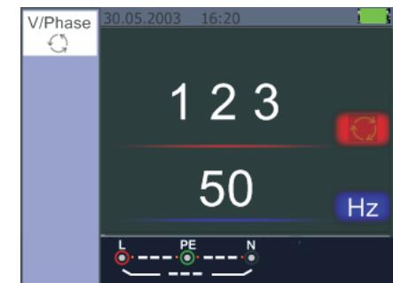
Abbildung 23 Phasenfolge-Bildschirm - wenn im Uhrzeigersinn verbunden.
